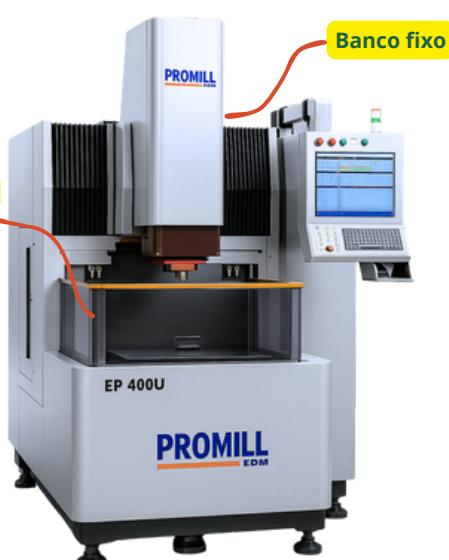
Projetadas sobre uma das melhores e mais confiáveis estruturas tipo C do mercado, essa série conta com banco fixo e tanque elevatório com nível automático de dielétrico, o que possibilita uma infinita capacidade de automações e integrações com sistemas externos.
